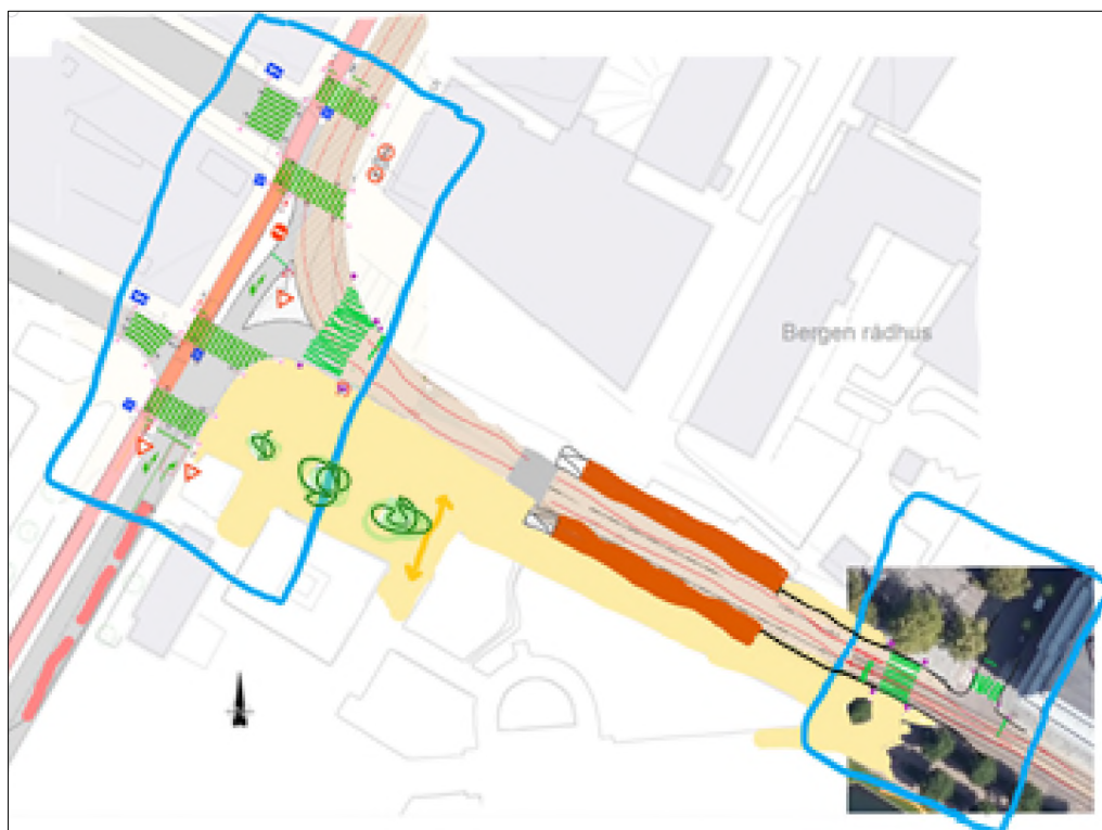
Figur 11 Optimalisert løsning med parallelle plattformer.
