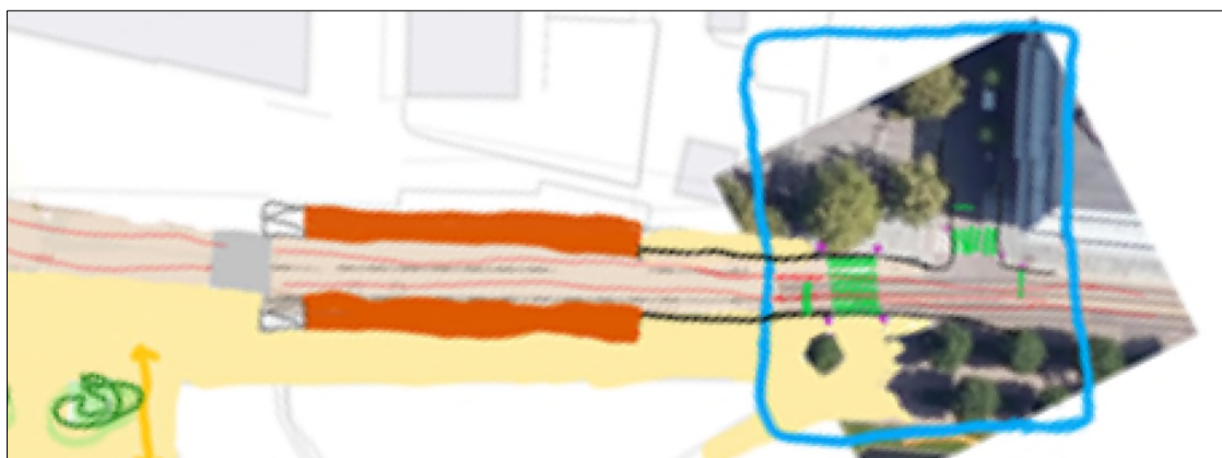
Figur 9 Anbefalt organisering av holdeplass med parallelle plattformer.
